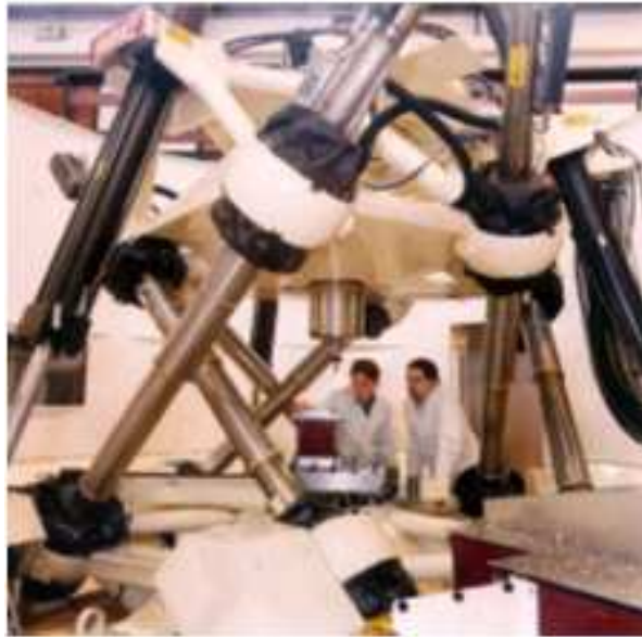
Figure 1.12- La Variax de Gidding and Lewis : Fraiseuse cinq axes.
