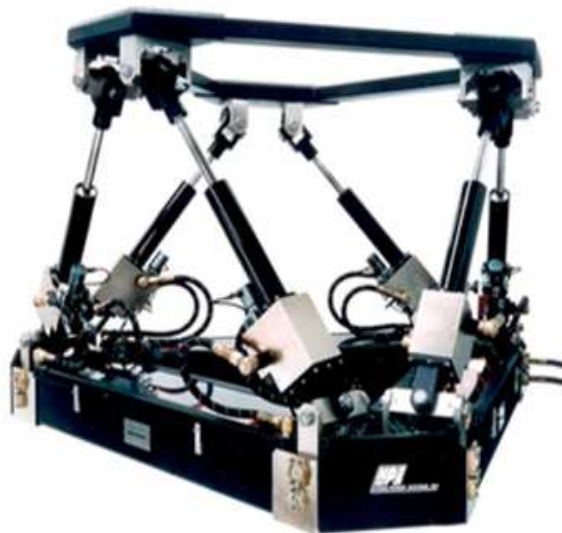
Figure 1.4- Plate-forme de Stewart.
