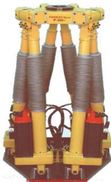
Figure 5.1- robot à 6 ddl "F-200i" de Fanuc Robotics.
