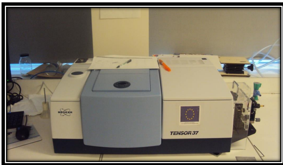
Figure : III.13 Photo du spectrophotomètre du type : Bruker Tensor 37
