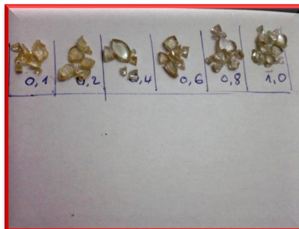
Figure II.2 Photo de verres du système : (1-X) \text{Sb}_2\text{O}_3 - 30\text{PbCl}_2 - X \text{Pr}_6\text{O}_{11}
