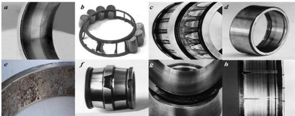
Figure 32 – Quelques défaillances affectant les roulements a- Usure généralisée b- Cage détériorée c- Corrosion d- Présence de cratères e- Écaillage f- Fissure et cassure g- Grippage h- Trace d'empreintes (Khelf,2014 )
