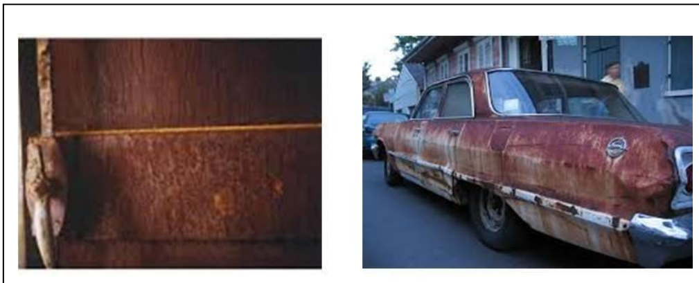
Figure I.4. : Corrosion générale (rouille) d'une pièce en acier [11].
