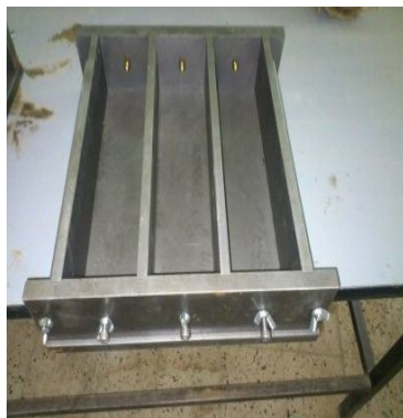
Eprouvettes prismatiques 7×7×28 cm équipées de plots
