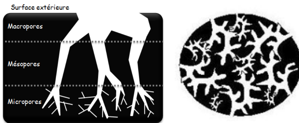
Figure I.6 : Représentation schématique d'un grain poreux de charbon actif obtenu par activation [47,48].
