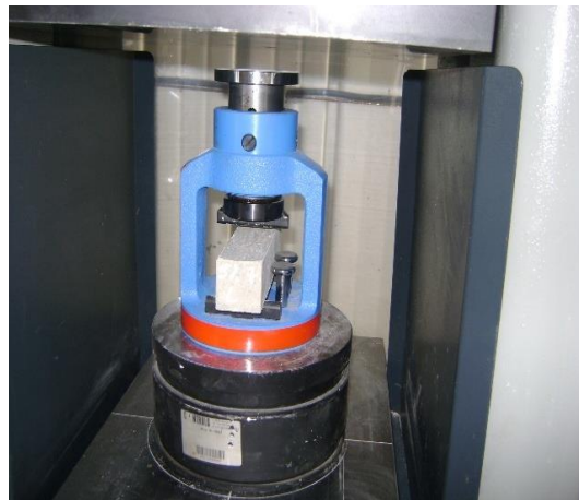
Photo 3. 6 : Dispositif de charge en flexion pour les éprouvettes de mortiers
