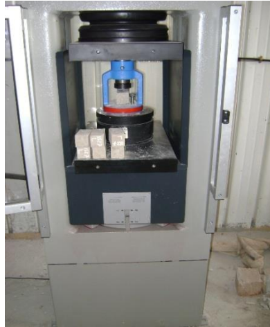
Photo 3. 5: Dispositif de charge en compression pour les éprouvettes de mortiers.
