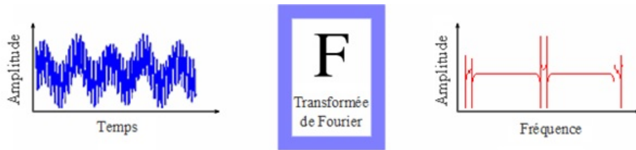
FIGURE 2.12 – Transformée de Fourier d'un signal de série temporelle
