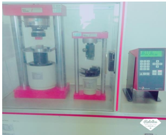
Photo III. 10 : Dispositif de charge en compression pour les éprouvettes de mortiers
