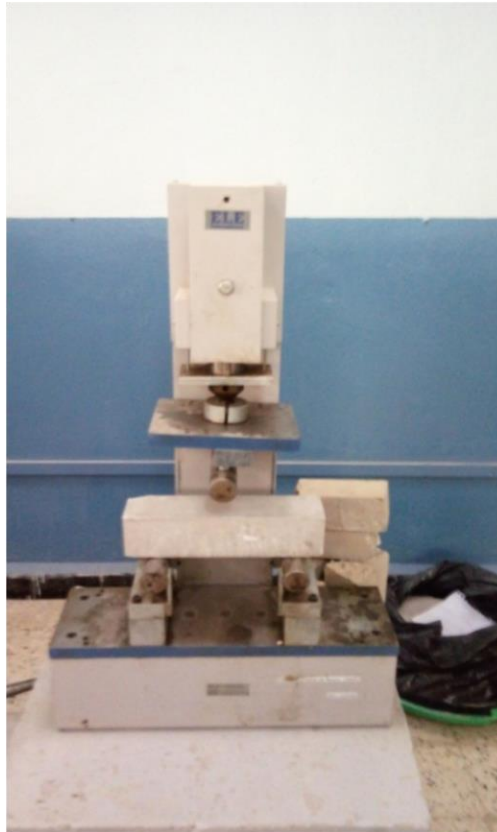
Photo 13 : Essai de traction par flexion trois points.
