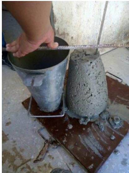
Photo 11: Mesure de l'affaissement au cône d'Abrams.
