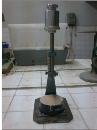
Figure III.14 : Mesure du temps de prise (Appareil de Vicat)
