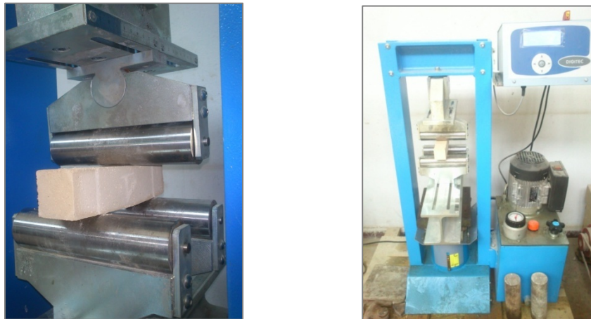
Figure III.15 : Essai de traction par flexion 3 points sur les éprouvettes 4x4x16 cm
