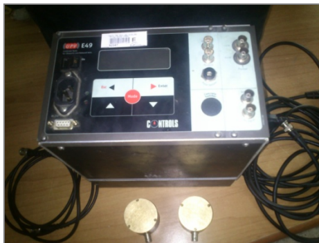
Figure III.18 : Appareil à ultrasons utilisé : controls modèle 58-E0048 avec fréquence de 54 kHz (Du laboratoire d'Hydraulique et de Génie Civil de l'université de Guelma)
