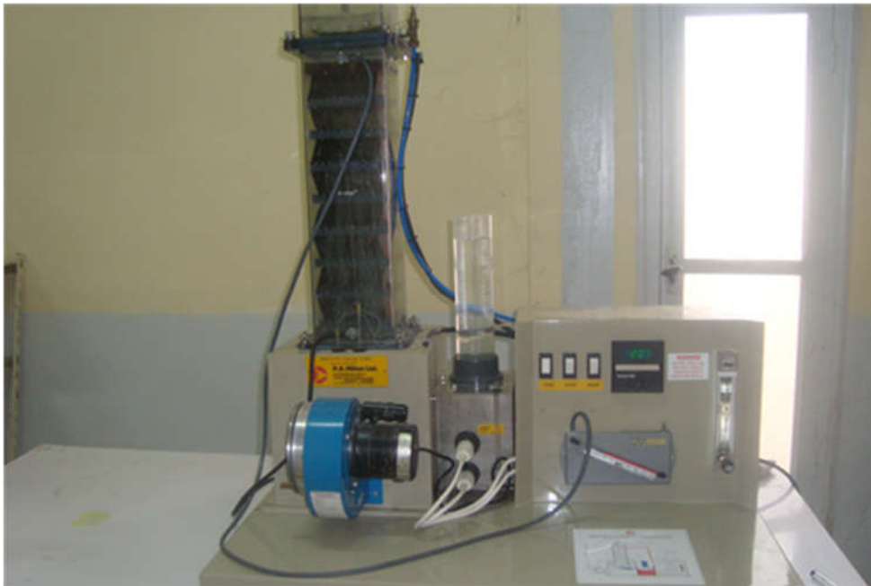
Fig. IV.1 : Tour atmosphérique de type BENCH P.A Hilton H891 disponible au laboratoire de transferts thermiques de l'université 08 Mai 1945 de Guelma.
