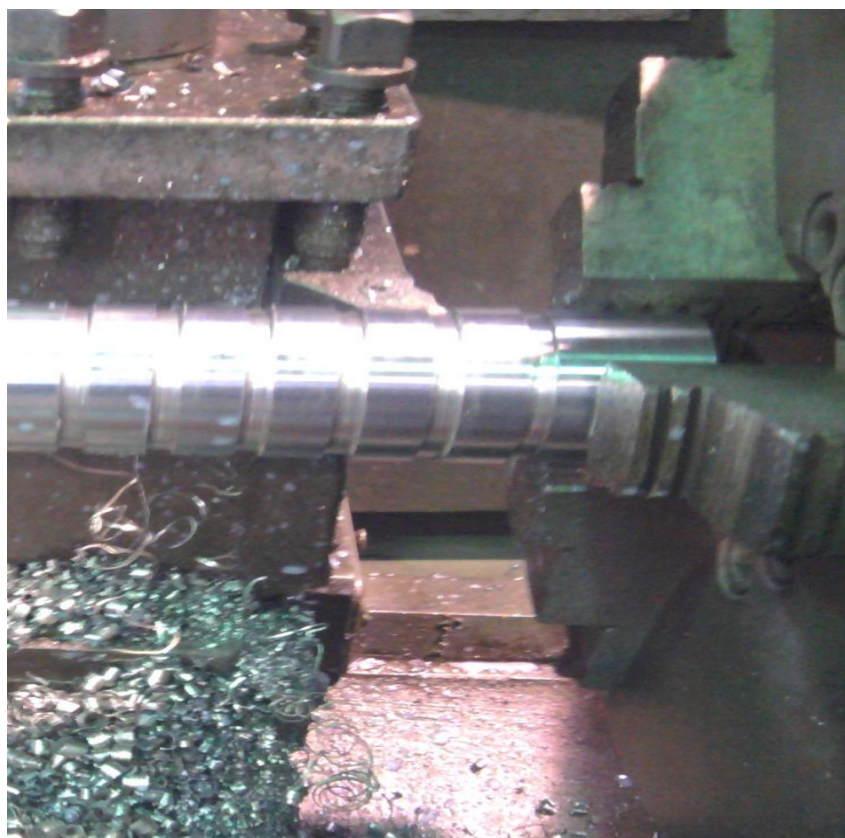
a. Chariotage de la barre en acier C45
