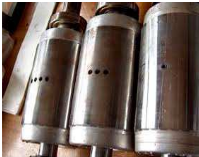
Fig. IV. 2 Défaus de rupture de barres
