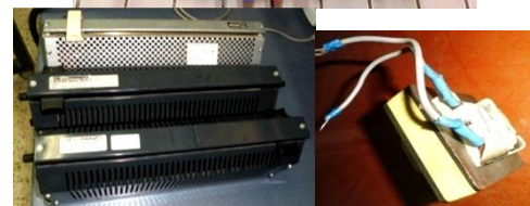
Charge non linéaire : pont de diode triphasé, charge résistive, inductance.
