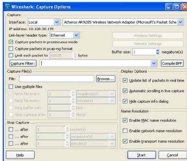
**Figure V-25 : Réglage de l'interface de la capture**
